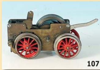
**MÄRKLIN Uhrwerk-Platinenmotor, Spur 1**
