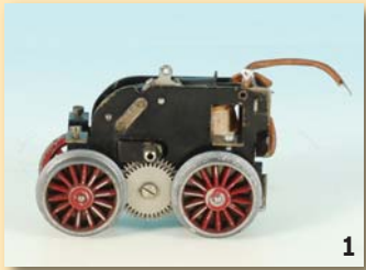
MÄRKLIN Lok-Motor 12880 deutliche Gebrauchsspuren, 1 Rad kaputt, Ersatzteilspende. 30,- €
